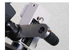
■正立極望 極軸と雲台の間にステータス を挟むことによって、あらゆるポータブル赤道儀に装着可能な正立像の極望です。
