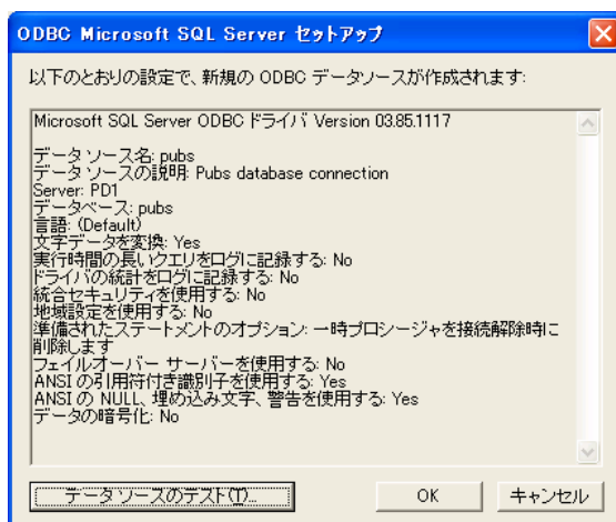
図 5 . 「データソースのテスト」ボタンをクリックして接続の確認をします
