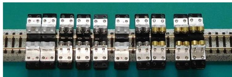
鉄道模型車輛のモーター駆動車輛やその台車は、実物をスケールダウンしたものですから、回転車輪の数や位置が異なります。ブロックに乗せる車輛の回転車輪がどの位置にあるかを前もって調べておきます。
