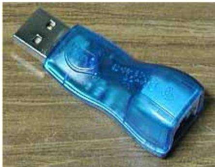
DS2751Eの回路だけを作成して、この回路のDQ端子と写真のようなDS9490RというUSBと1-WireのI/FアダプターとをRJ-11の電話機用のモジュラーケーブルで接続することも出来ます。
