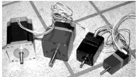
E-ZEUSは赤道儀ごとにオリエンタル製の様々なモーター採用しています。標準パッケージはPKシリーズです。装着法は赤道儀によって異なります。
